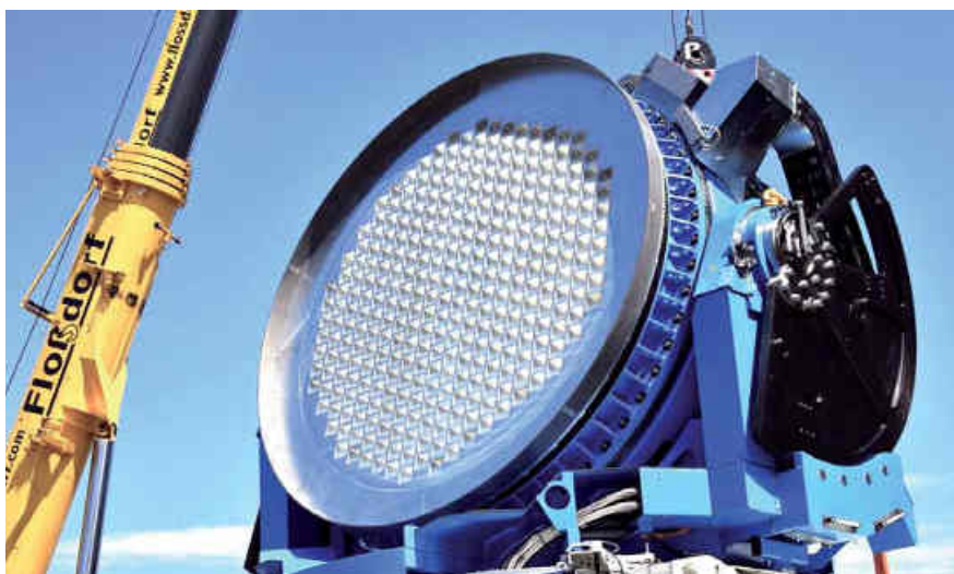
Ein Beispiel für deutsche Radartechnologie: Der in alle Richtungen bewegliche Antennendrehstand trägt die GESTRA-Antenne bei Koblenz mit ihren 256 digital angesteuerten Elementen. Foto: Fraunhofer FHR/Uwe Bellhäuser
