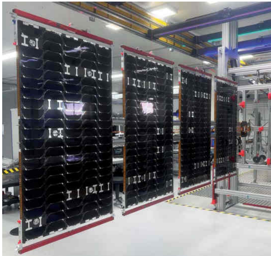
Ausklappbarer Solarflügel im STI Reinraum beim Ausklapptest. Fotos: STI
