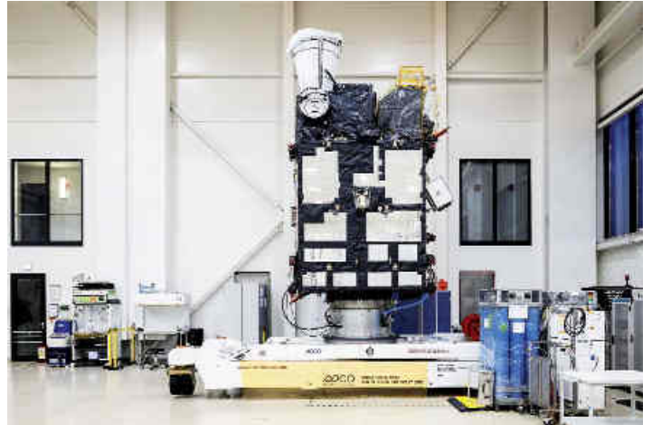
Der neue europäische Wettersatellit MTG-S1 hier in einem Reinraum bei OHB, bevor er im Juli 2025 gestartet wurde. Mit seinem Infrarot-Sounder-Instrument wird er die Wettervorhersagen erheblich verbessern.
