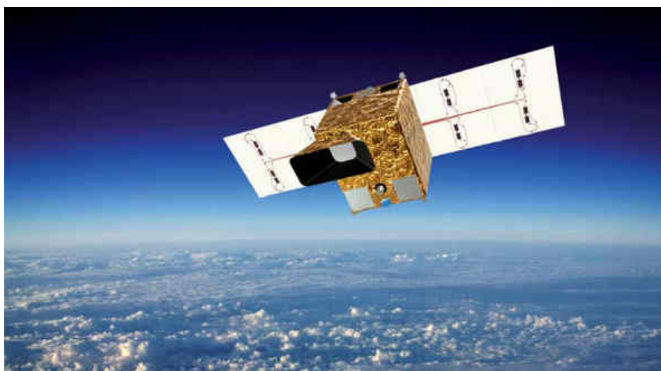
DIEGOSat verfügt über 13 spektrale Bänder vom sichtbaren Licht bis ins thermale Infrarot. FOTO: viSales / Astrofein
