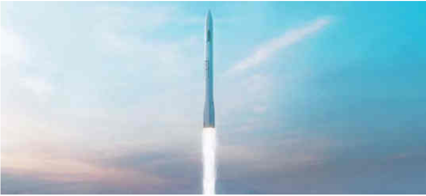
Visualisierung der dreistufigen Orbital-Trägerrakete SL1 für den Transport von Satelliten und anderen Nutzlasten von bis zu 600 Kilogramm in den niedrigen Erdborbit.
