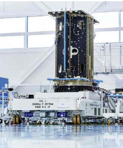
Blick in einen der OHB-Reinräume: Einer der drei CO2M-Satelliten ist hier in seiner frühen Phase des Baus zu sehen. Fotos: OHB
