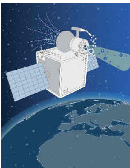
Abb 3: Künstlerische Darstellung eines Satelliten mit luftatmendem Triebwerkssystem. Der Satellit bewegt sich auf einen VLEO etwa mit 8 km/s in der Restatmosphäre. Diese soll mit dem Trichter (Kollektor) gesammelt und 100fach komprimiert werden, um dann als Treibstoff genutzt zu werden. Grafik: Elisa Monte, JLU
