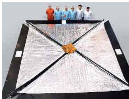
Deorbit-Segel ADEO-L mit 25 m 2 (Produkt aus dem GSTP-Programm, demnächst Flug auf einem Redwire-Satelliten), Foto: HPS/DLR
