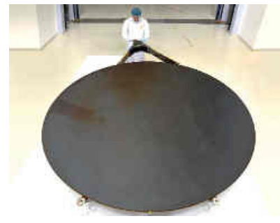
2,4m Q/V-Band Antennenreflektor (Produkt aus dem ARTES-Programm, Technologie eingesetzt auf EUCLID, HERA und demnächst VIGIL), Foto: HPS
