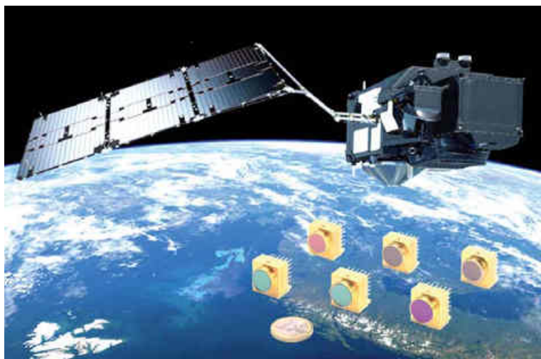
Sentinel-3: SWIR-VLWIR Detektoren zur Klima- und Erdbeobachtung. Foto Satellit: ESA/ATG medialb. Inlay: AIM
