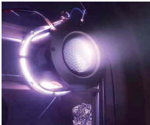
Referenz-Gitterionenquelle als Strahlnormal zur Validierung von Strahlagnostik, entwickelt im DLR-Verbundvorhaben Ref4EP. Foto: D. Spemann, ©IOM
