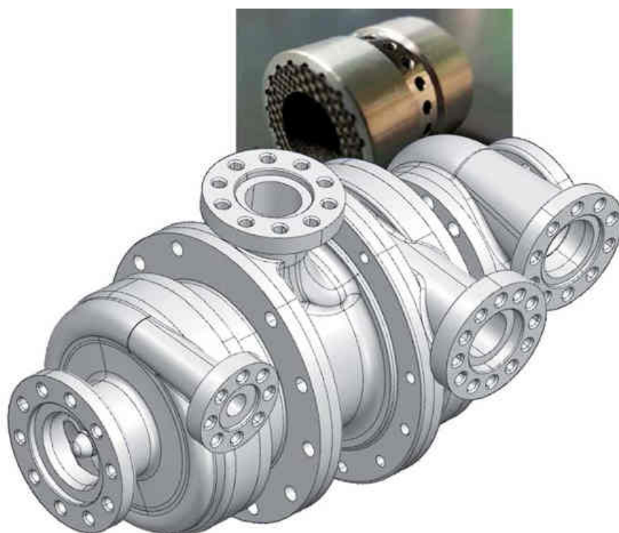
Demonstrationstest für einen 2,5 kN Kerosin/Wasserstoffperoxid Antrieb.
