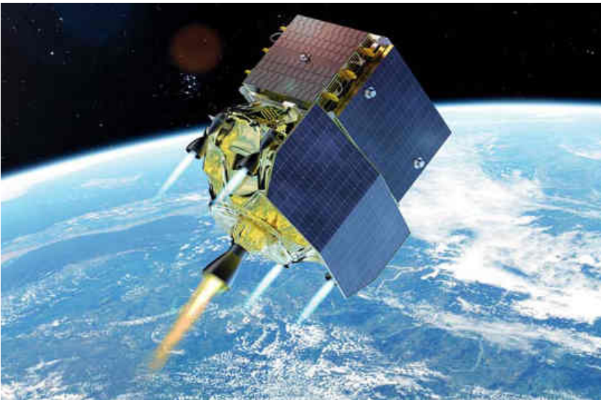
Visualisierung des HyMove-Weltraum-Transportsystem zur Unterstützung bei Bahnhaltung, Umlaufbahnkorrekturen und interplanetaren Transfers. Fotos: Hylmpulse
